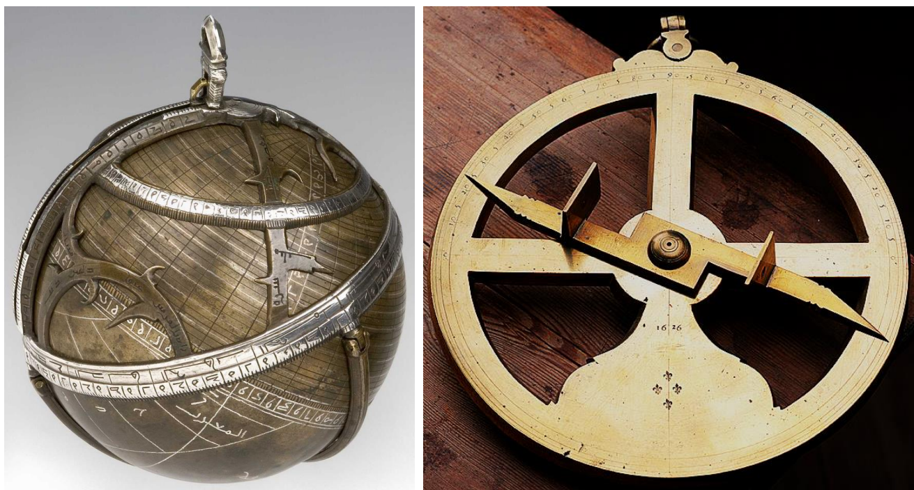
Figuur 5: Sferisch astrolabium (links) en nautisch astrolabium (rechts) (foto's: Creative Commons)
